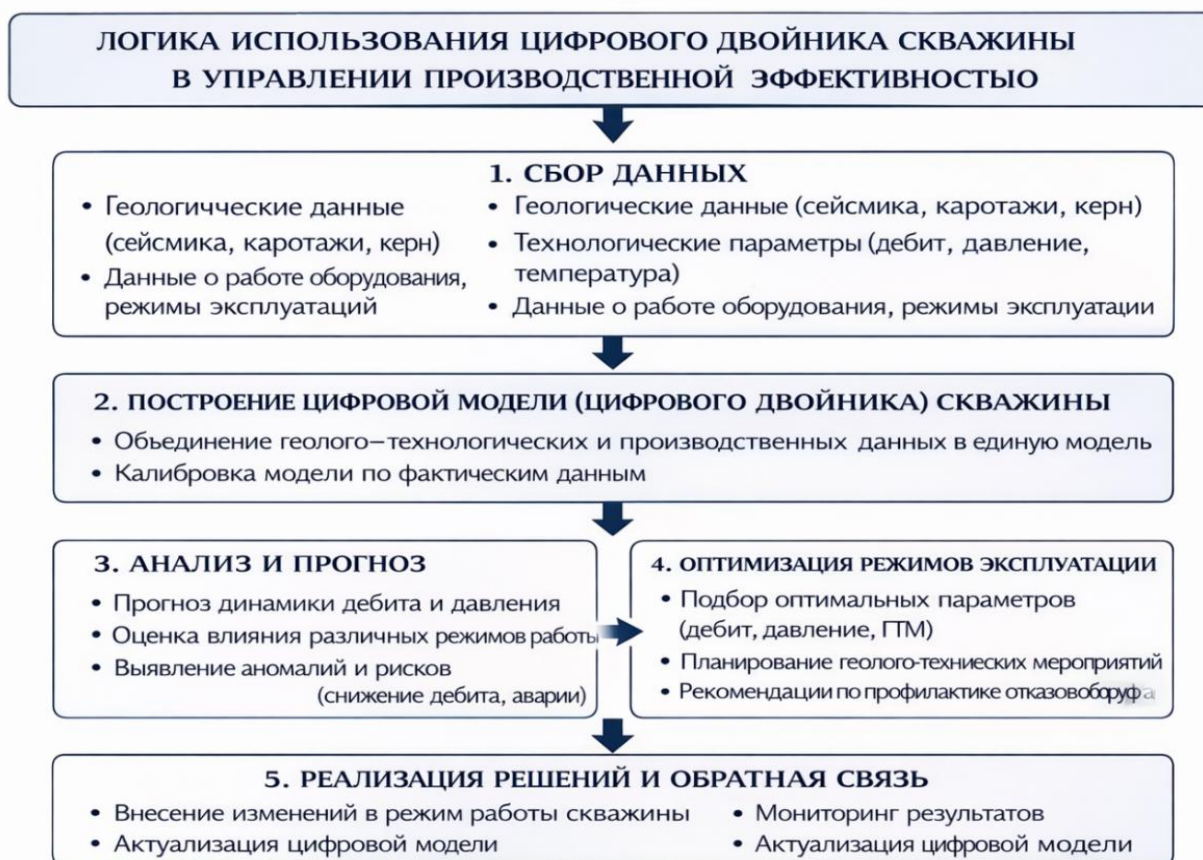
4-рисунок. Логика использования цифрового двойника скважины в управлении производственной эффективностью 14
