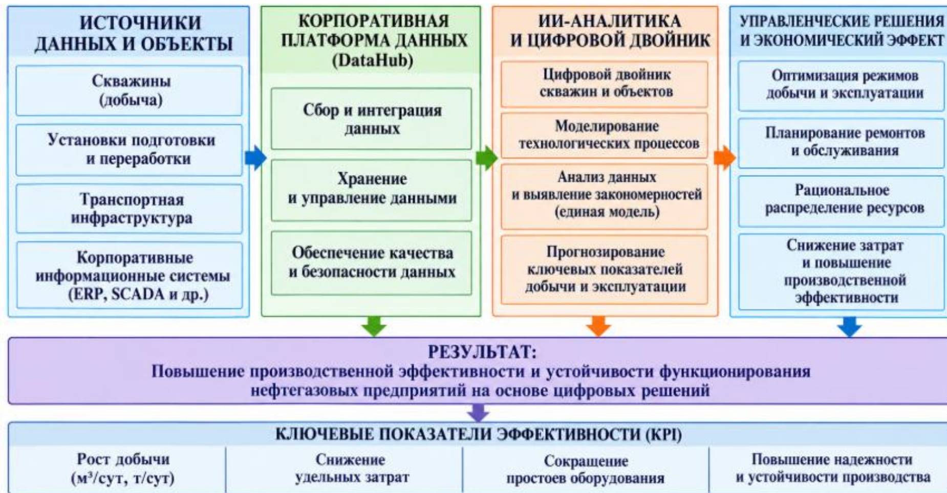
6-рисунок. Авторская схема интеграции цифрового двойника и ИИ на уровне скважин для повышения производственной эффективности и оценки экономического эффекта в ИП ООО «Sanoat energetika guruxi» 16
