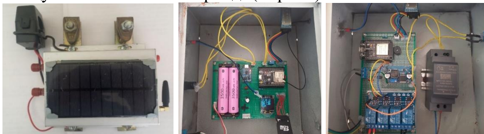
9-расм. Ток сенсорли нейтрал ўрнатмаларни фазалараро қисқа туташув тоқларидан ҳимоялаш қурилмаларининг синов модели
