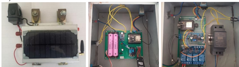
Рис. 9. Тестовая модель устройств защиты нейтральных ток сенсорных установок от токов межфазного короткого замыкания
