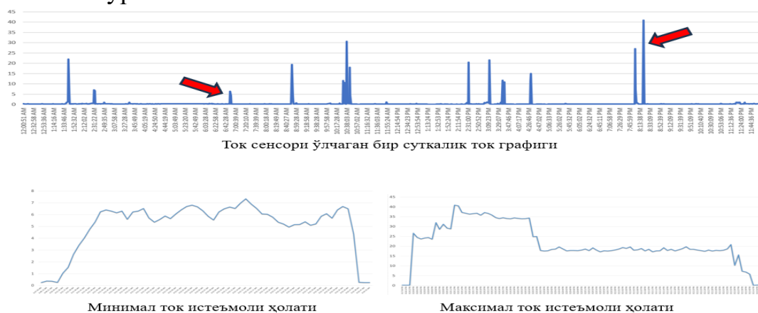
Рис 10. График суточного изменения силы тока, измеренного датчиком тока
