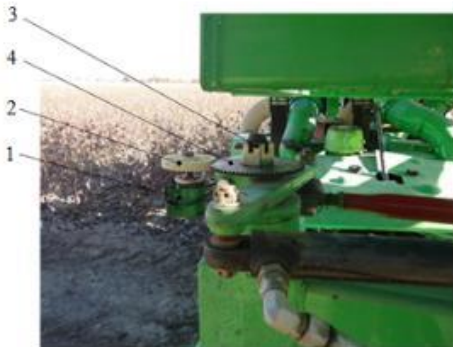
1–потенциметрический датчик; 2–пластиковое зубчатое колесо, установленное на оси датчика; 3–ось вилки НК; 4–зубчатое колесо, установленное на оси вилки
