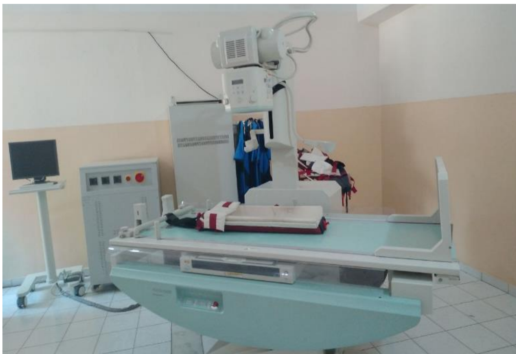
\\5.1-расм. “Flexa Vision” ясси детекторли стационар рақамли рентген аппарати (Shimadzu Corporation, Япония)
