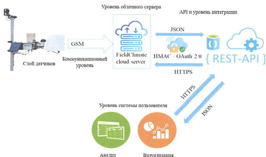
Рис. 17. Архитектура интеграции данных устройства с API.
