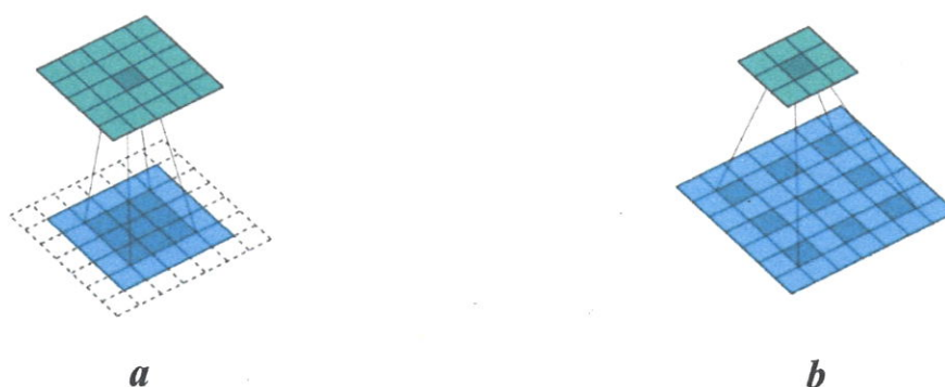
Рис. 10. Обычный и расширенный сверточные слои. a – обычный сверточный слой (фильтр: 3 \times 3 , шаг: 1); b – расширенный (dilated) сверточный слой (фильтр: 3 \times 3 , \text{dilation rate} : 2 ).
