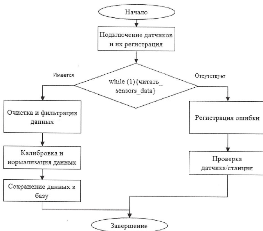
Рис. 16. Блок-схема общего алгоритма получения и сохранения данных от сенсоров.
