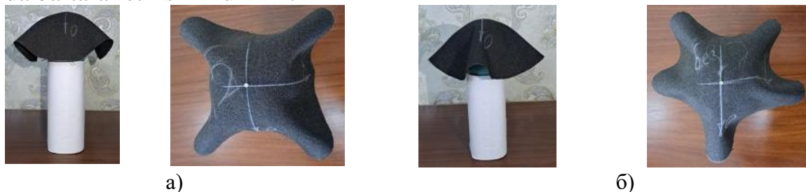
9-rasm. Gazlamani shar yuzasidagi o'zini tutishida tanda ipi yo'nalishi bo'yicha preparat bilan ishlov berilgan (a) va berilmagan (b) namunaning №2 taxlama hosil qilishining qiyosiy tahlili. Polimer kompozitsiyaning konsentratsiyasi - 0,5 g/l.
