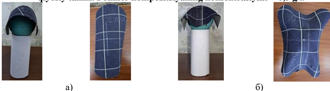
10-rasm. Gazlamani shar yuzasidagi o'zini tutishida tanda ipi yo'nalishi bo'yicha preparat bilan ishlov berilgan (a) va berilmagan (b) namunaning №1 taxlama hosil qilishining qiyosiy tahlili. Polimer kompozitsiyaning konsentratsiyasi - 50,0 g/l.
