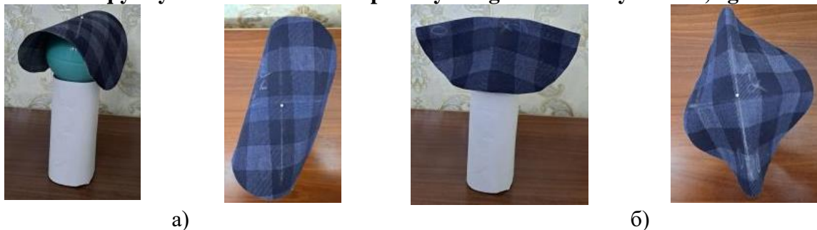
11-rasm. Gazlamani shar yuzasidagi o'zini tutishida tanda ipi yo'nalishi bo'yicha preparat bilan ishlov berilgan (a) va berilmagan (b) namunaning №3 taxlama hosil qilishining qiyosiy tahlili. Polimer kompozitsiyaning konsentratsiyasi - 50,0 g/l
