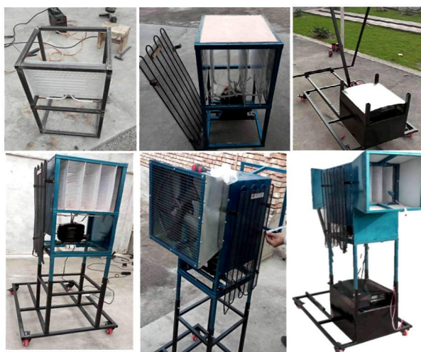
Рис. 6. Процессы подготовки и обзор установки дополнительного охлаждения масляных силовых трансформаторов с системой охлаждения М (ONAN)
