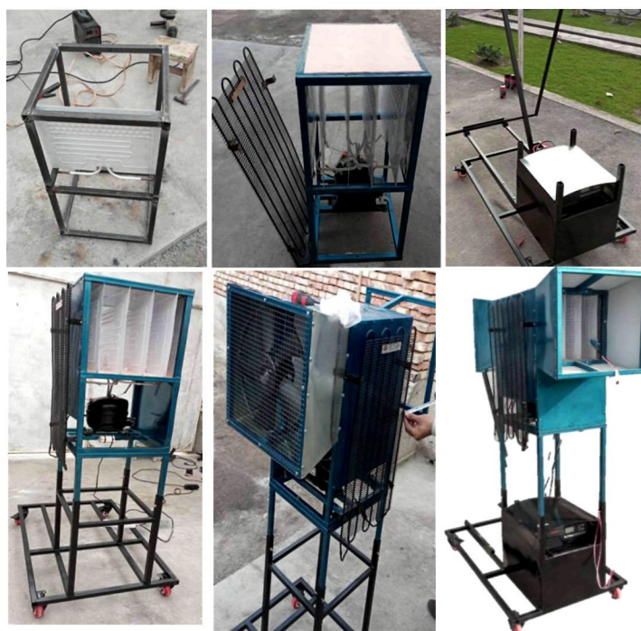
6-rasm. M(ONAN) sovitish tizimiga ega moyli kuch transformatorlarini qo‘shimcha sovitish imkonini beruvchi qurilmasining tayyorlanish jarayonlari va umumiy ko‘rinishi
