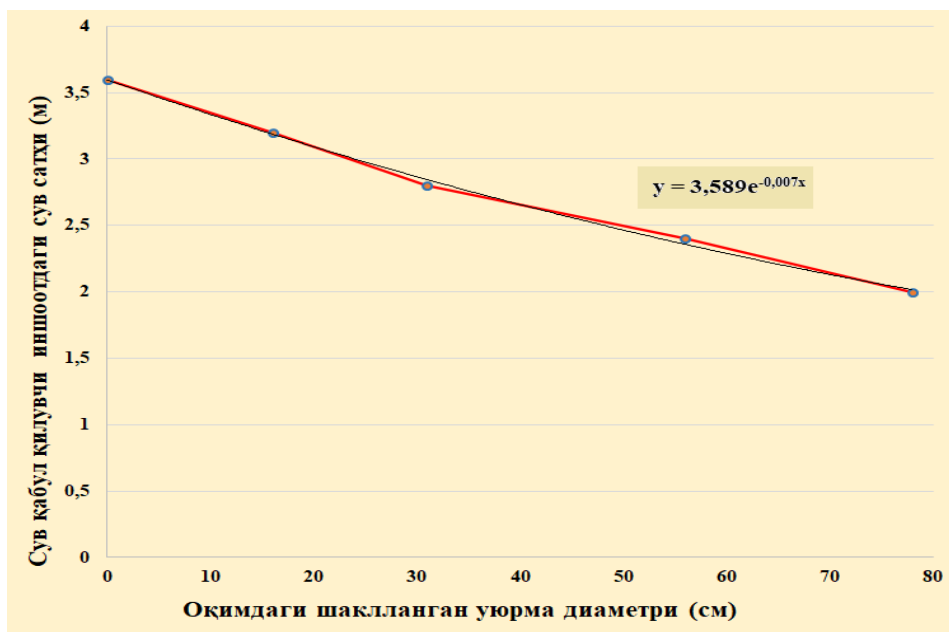
б-расс. Сув қабул қилувчи иншоот сув сатҳининг уюрмалар диаметрига боғлиқлик графиги (10 м 3 /сек. сарфли насос агрегати учун)
