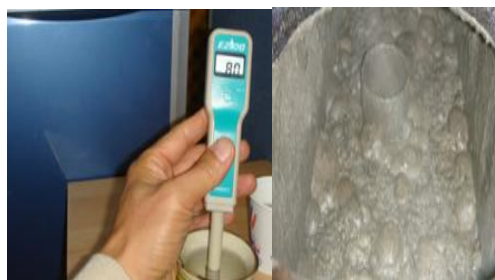
10-rasm. Tajribalar o'tkazish davrida haroratining 14 \pm 2^\circ\text{C} holatida pH miqdori 7,1 - 8,5 atrofida o'zgaruvchanligi holati
