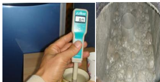
Рис.10. Изменчивость показателя рН в пределах 7,1 - 8,5 при температуре 14 \pm 2^\circ\text{C} в период проведения экспериментов
