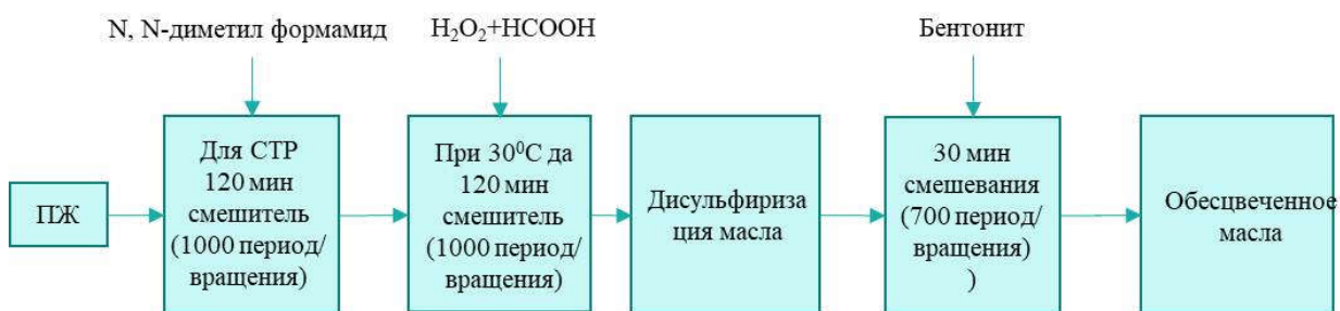
Рис. 9. Процесс десульфуризации и обезвоживания жидкости, полученной из вторичных и изношенных резиновых изделий
