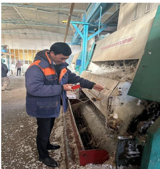
10-rasm. Konveyer tasmali tezlatichni ishlab chiqarish tizimiga joriy etish va sinovdan o'tkazish.
