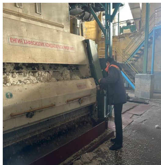
10-rasm. Konveyer tasmali tezlatichni ishlab chiqarish tizimiga joriy etish va sinovdan o'tkazish.
