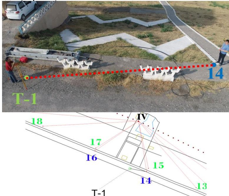
**7-расм. Жиззах сув омбори худудини электрон тахеометр ёрдамида топографик съёмка қилиш жараёни**
