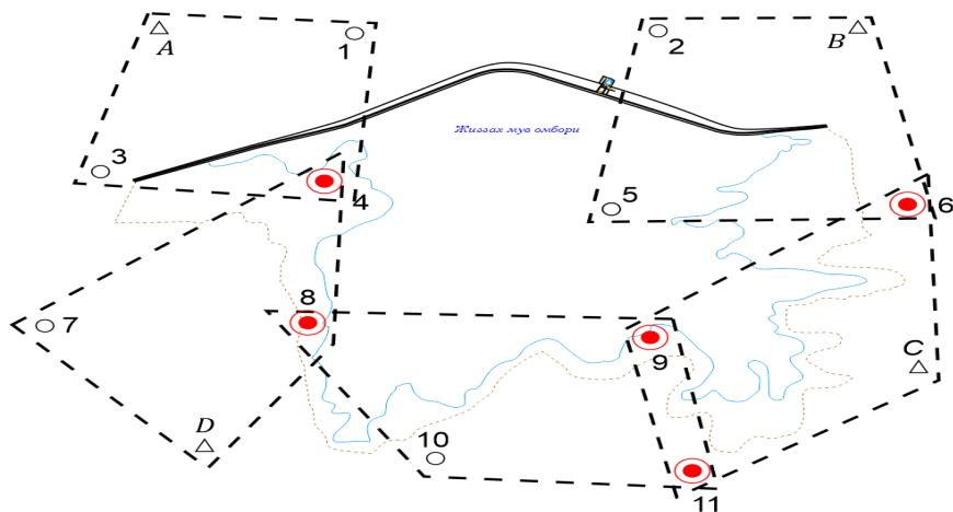
**2- расм. Приёмникларни ўрнатиш схемаси**
