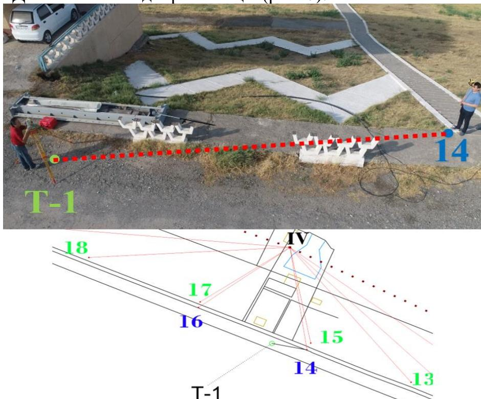
**Рисунок 7. Процесс топографической съемки района Джизакского водохранилища с использованием электронного тахеометра**
