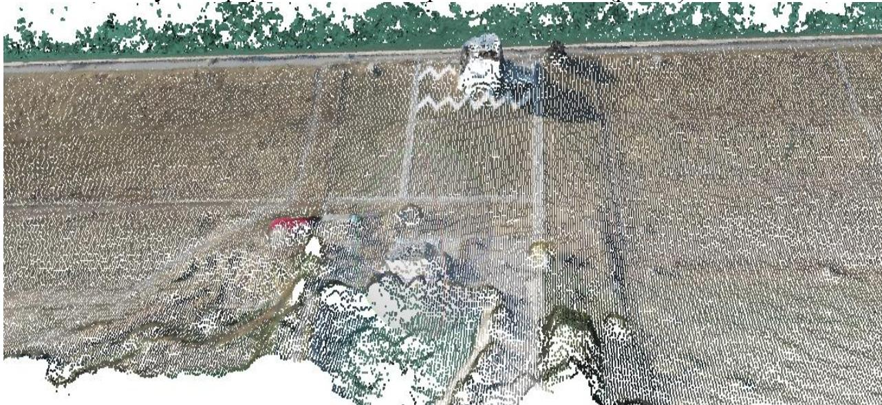
**Рисунок 5. Результаты 3Д лазерного сканирования плотины Джизакского водохранилища**
