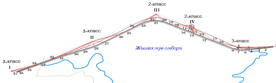
**Рисунок 4. Схема расположения нивелирных сетей и реперов на Джизахском водохранилище**
