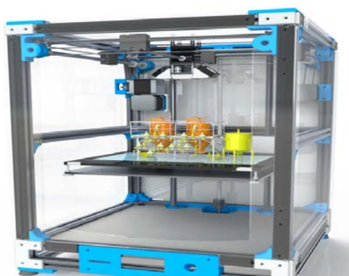
Рисунок 2. 3D принтеры: трехмерный принтер-это устройство, способное формировать объекты на основе созданных цифровых 3D-моделей.
