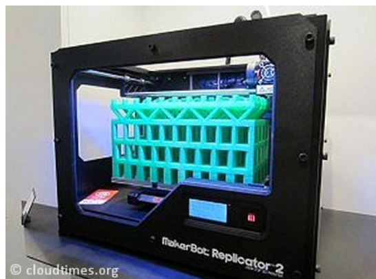
Рисунок 2. 3D принтеры: трехмерный принтер-это устройство, способное формировать объекты на основе созданных цифровых 3D-моделей.
