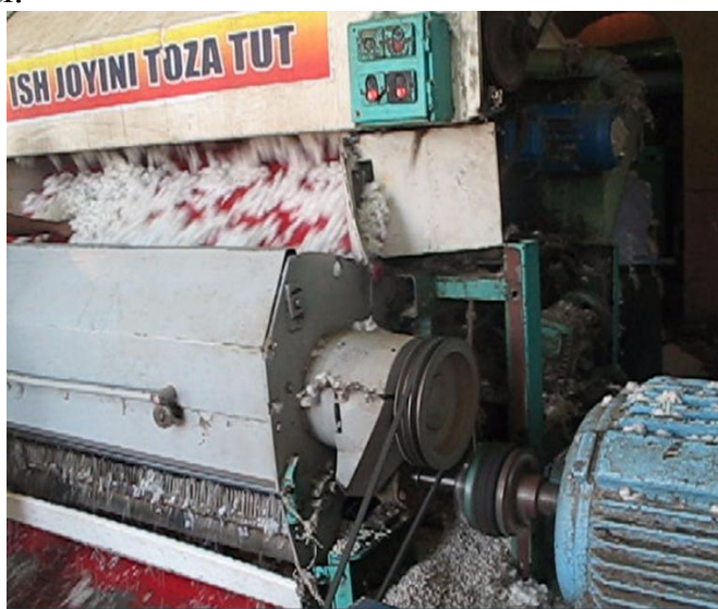
17-rasm. 8DP - 90 arrali tola ajratgichning takomillashtirilgan chigit chiqaruvchi quvur bilan jihozlangan ishchi holati
