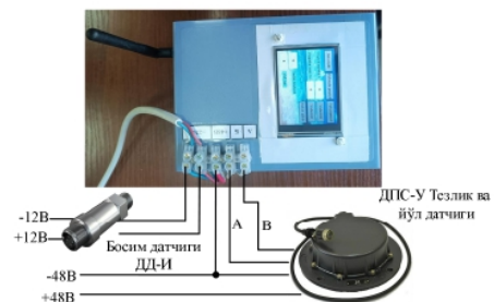
8-расм. Локомотив борт қурилмаси уланиш схемаси
