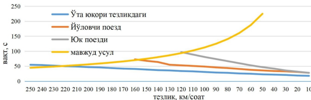
11-расм. КАС тизимида поездни кесишмага яқинлашиш вақтининг тезликка боғлиқлик графиги
