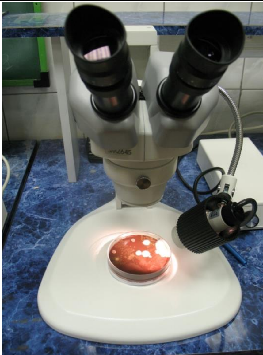
69-rasm. Tadqiqot stereomikroskopi (Nikon firmasi) mikroorganizmlar koloniyalarining morfologiyasini hisoblash va o'rganish uchun.
