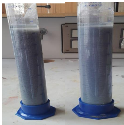
Рис.8.Начало процесса хлопьеобразования и осаждения, 1-цилиндр без флокулянта. 2-цилиндр с флокулянтом серии «Унифлок» D= 0,1 мг/л.
