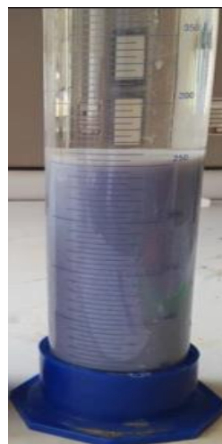
11-расм. Ивиклар ҳосил бўлиши ва чўкиш жараёнининг тугалланиши ( t=60 мин)
