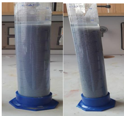
8-расм. Ивиклар ҳосил бўлиши ва чўкиш жараёнининг бошланиши. 1-цилиндр флокулянтсиз. 2-цилиндр «Унифлок» флокулянти билан D = 0,1 мг/л
