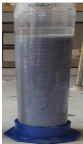
Рис.10. 10 минут после начала процесса хлопьеобразования и осаднения
