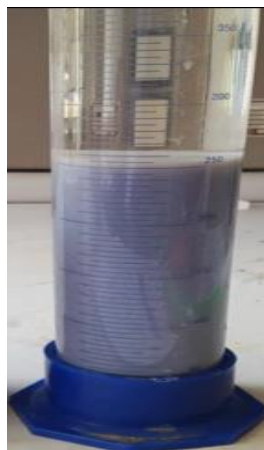
Рис.11 Окончание процесса хлопьеобразования и осаднения (t=60 мин)
