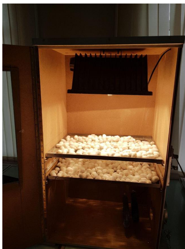
Рис. 6.4. Первичная переработка коконов тутового шелкопряда с помощью горячего воздуха (конвективная)
