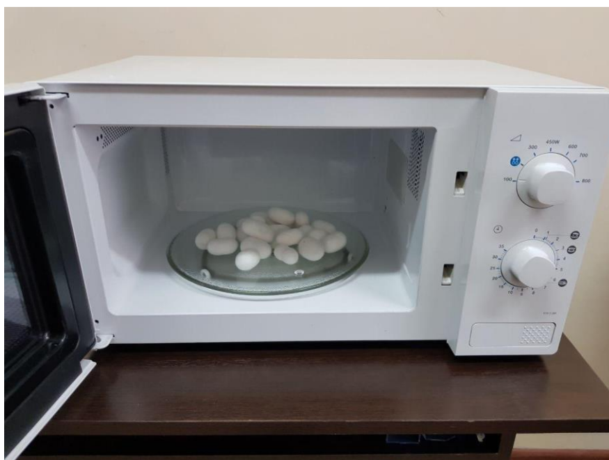
Рис. 6.3. Первичная переработка коконов тутового шелкопряда с помощью СВЧ
