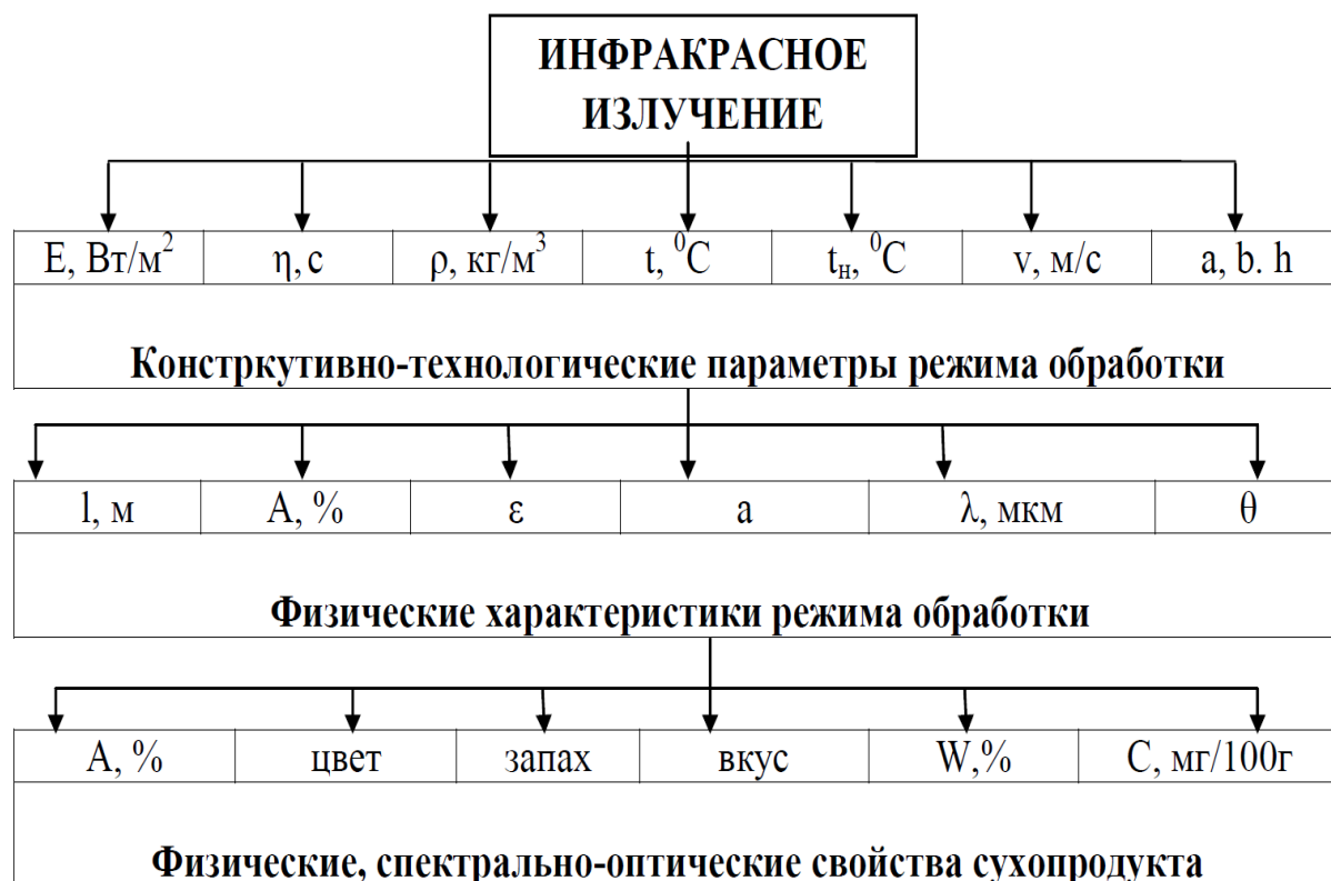
Рис. 2.22. Влияние конструктивно-технологических параметров процесса сушки на основные свойства сухопродукта
