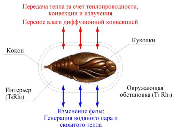
Рис. 4.1. Процесс переноса тепла и влаги всего кокона
