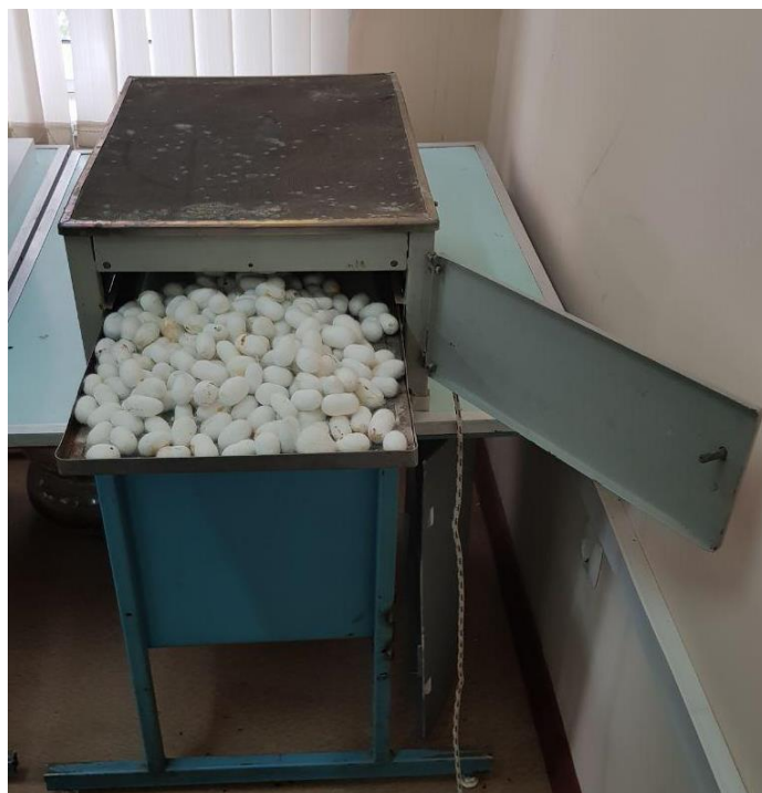
Рис. 6.2. Первичная переработка коконов тутового шелкопряда с помощью ИК-нагрева
