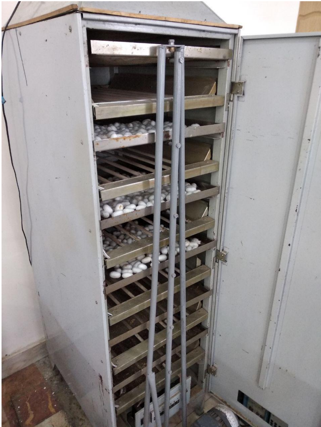
Рис. 6.5. Первичная переработка коконов тутового шелкопряда с помощью ИК-вибрации
