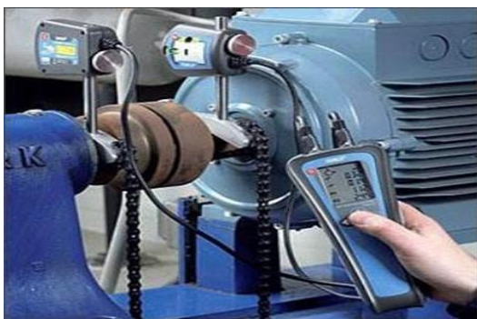
Рис. 6. Процесс использования лазерных инструментов модели SKF TKSA 20 и TKSA 31 для проверки соосности валов
