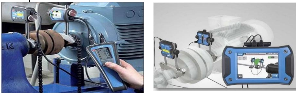
6-расм. Валларнинг мослигини текшириш учун SKF TKSA 20 ва TKSA 31- русумли лазерли асбобларни қўллаш жараёни тасвирланган
