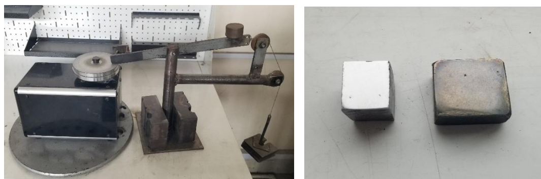
Рисунок 4. а) Общий вид установки для испытания на абразивный износ алмазного диска. б) Образцы, подготовленные для испытания на абразивный износ.
