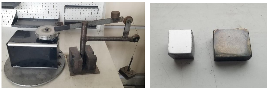
4-rasm. a) Olmos diskli yeyilish sinov qursilmasining umumiy ko‘rinishi. b) yeyilishga sinash uchun tayyorlab olingan namunalar.
