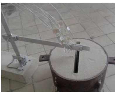
Рисунок 5. Опытная литейная форма перед заливкой. Видны термопары (датчики температуры), установленные в полости формы и в теле формы.
