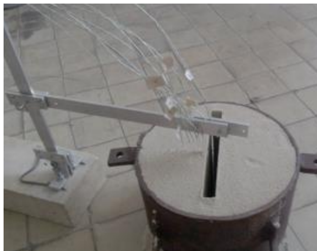
6-rasm. Quyishdan oldingi tajriba qolipi. Qolip bo'shlig'ida va qolip tanasida o'rnatilgan termojuftlar (harorat o'lchagichlar) ko'rinib turibdi.
