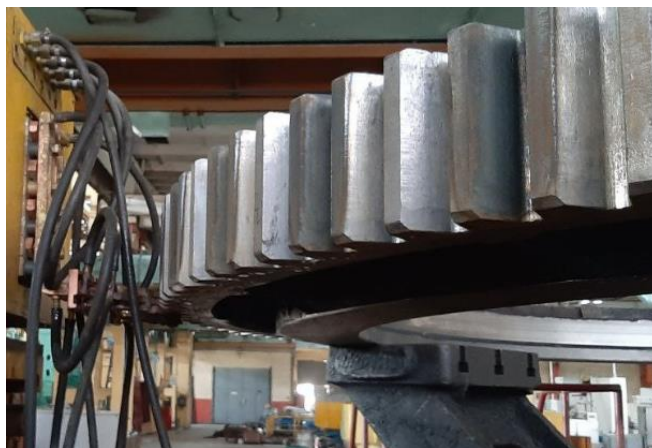
4-rasm. NMZ ICHB da mexanik ishlov berilgandan so'ng, tishlarni yuqori chastotali tok bilan termik ishlov berish jarayoni.
