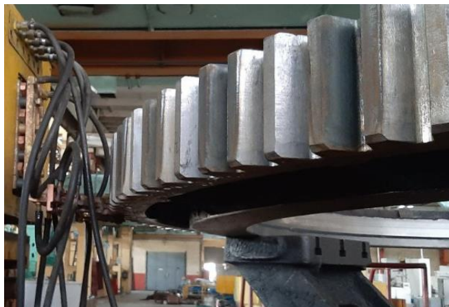
Рисунок 3. Процесс ТВЧ-закалки зубьев после механической обработки в условиях НМЗ.
