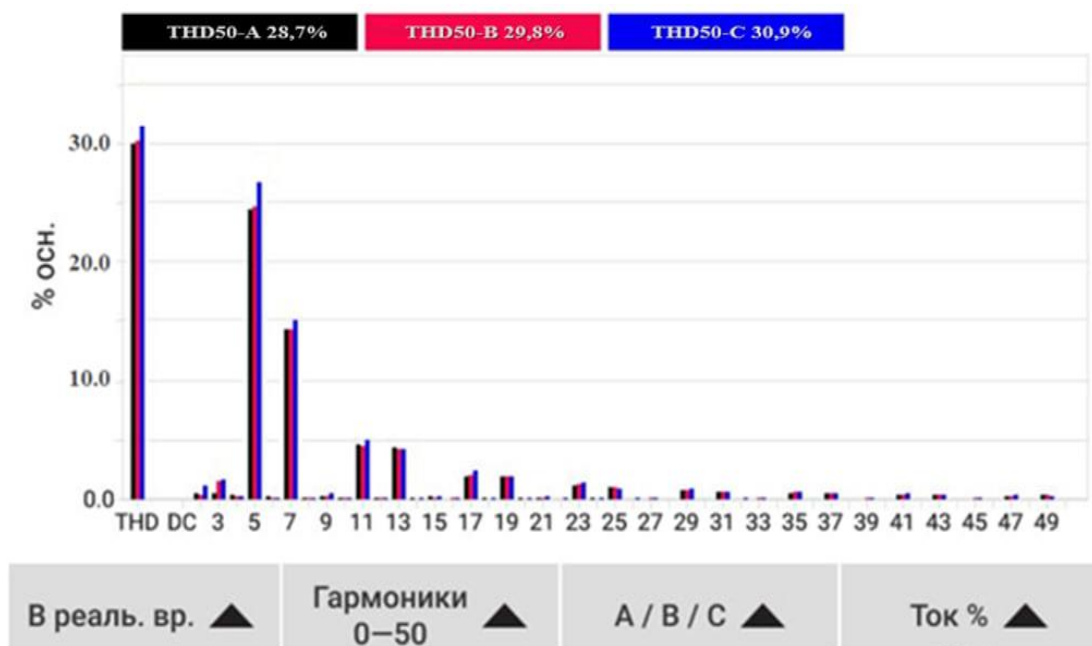
3-rasm. Korxona elektr tarmog'ida tok garmonikalarining spektral taqsimoti va umumiy garmonik buzilish koeffitsiyenti (THD) qiymatlari
