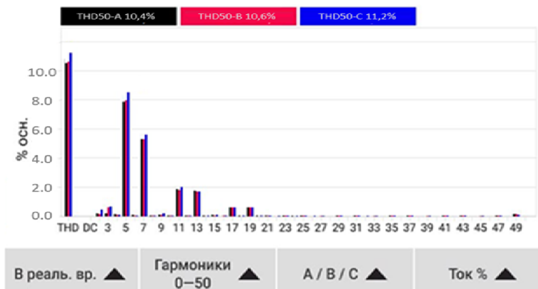
Рис. 7. Спектр гармоник тока и значения коэффициента THD в электрической сети
