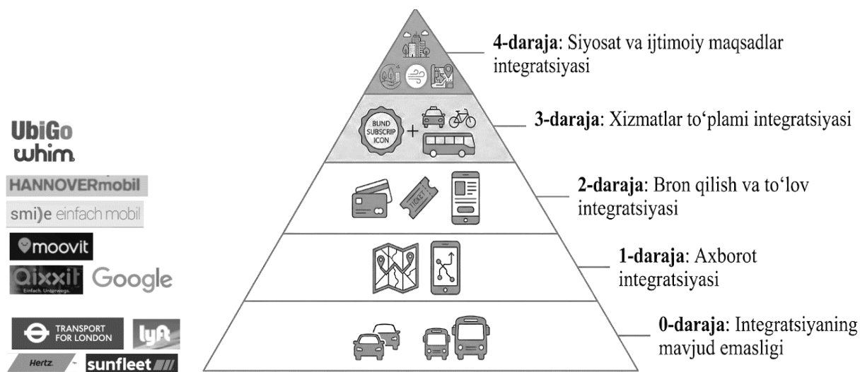
Рис.2. Иерархическая модель и примеры интеграции MaaS (Мобильность как услуга) (слева) 45
