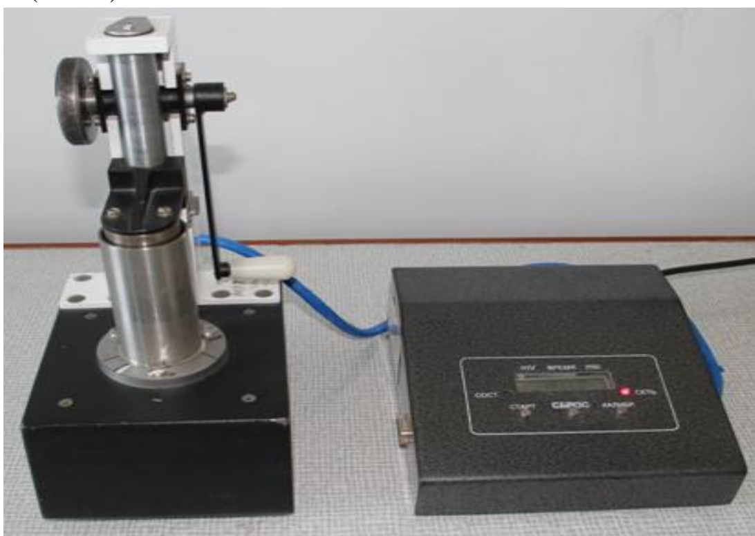
8-rasm. Paxta tolasining sifat ko'rsatkichlarini aniqlash uchun tayyorlangan akustik pribori
