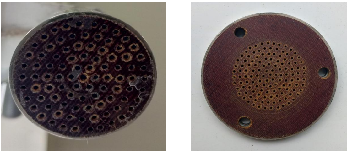
Рис. 4. Нижняя и верхняя перфорированные пластины.
