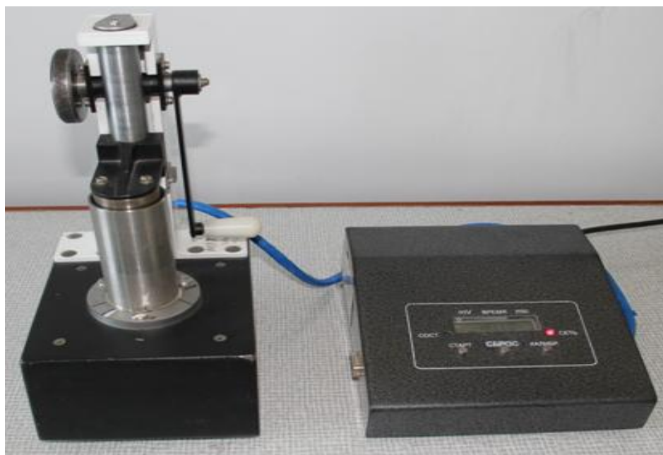
Рис. 8. Акустический прибор, подготовленный для определения качественных показателей хлопкового волокна
