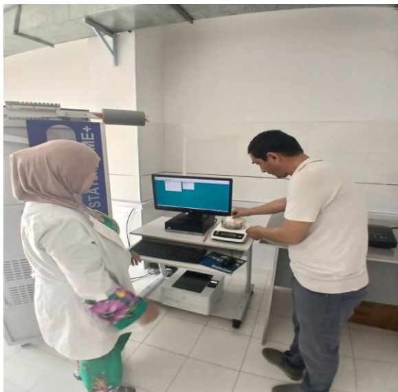
Рис. 9 Процесс взвешивания образца для испытаний
