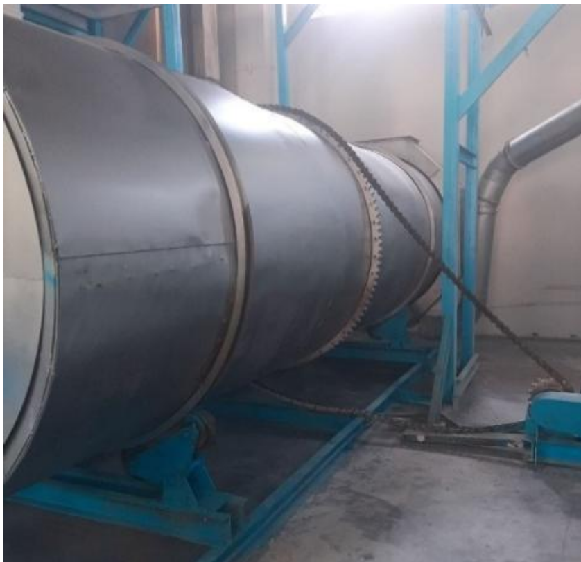
Рис.13. Общий вид предлагаемого малогабаритного барабана для сушки хлопка.
