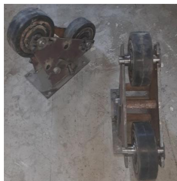
11-rasm. Paxtani quritish barabanining rolikli yurish qismining sxemasi va tayyorlangan variantda asosiy ko'rinishi.
