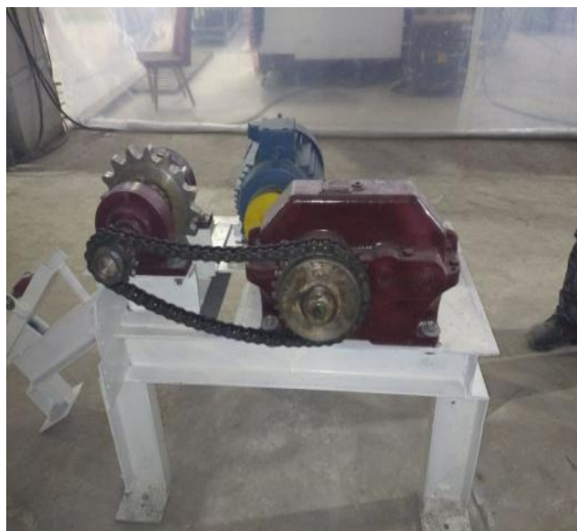
Рис.10. Процесс сборки приводной системы цепной передачи
