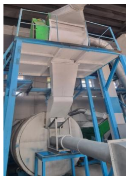
12-rasm. Quritish barabanini quritish agenti va paxta bilan ta'minlash tizimlari.
