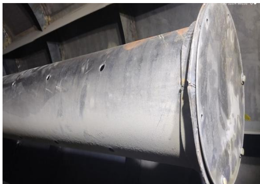
Рис.9. Внешний вид установки трубного устройства, предназначенного для радиального ввода примерно 30–40 % сушильного агента через трубу.
