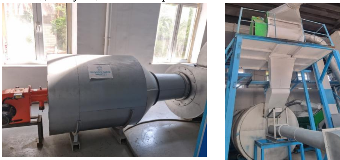
Рис.12. Системы подачи сушильного агента и хлопка в барабанную сушилку
