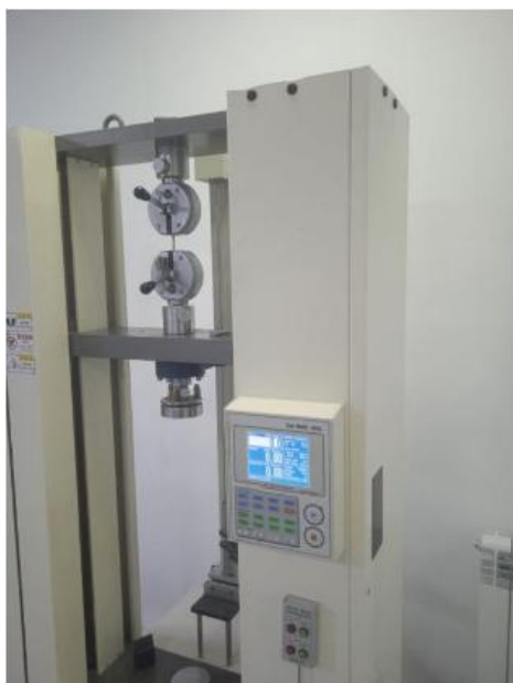
Рисунок 8. Определение прочностных показателей сплава при растяжении на универсальном тестовом оборудовании.
