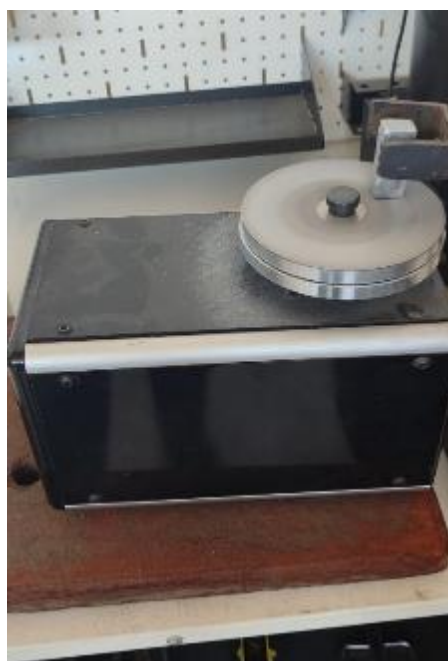
Рисунок 3. Процессы испытаний алюминиевых сплавов LM24 на износостойкость в зависимости от типов литых форм
