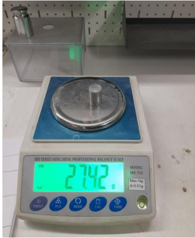
3-rasm. LM24 alyuminiy qotishmalarining quyma qolip turlariga bog‘liq holda yeyilishbardoshlik testi sinov jarayonlari.
