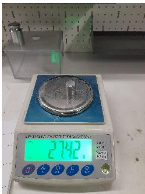
Рисунок 3. Процессы испытаний алюминиевых сплавов LM24 на износостойкость в зависимости от типов литых форм
