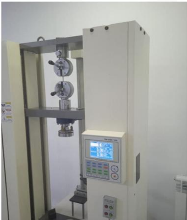
8-rasm. Universal test jihozida qotishmaning cho'zilishdagi mustahkamlik ko'rsatkichlarini aniqlash.
