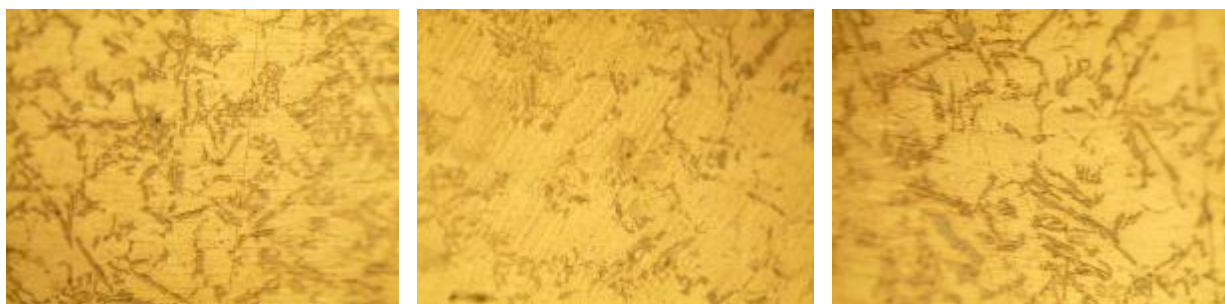
1 - rasm. LM 24 markali alyuminiy qotishmaning Nikon Eclipse LV150N metallografik mikroskopida olingan mikrostruktura tasvirlari.
