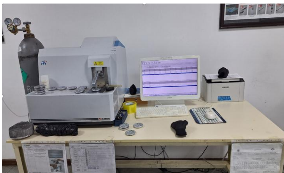
14-rasm. SPEKTROMETR-M5000 jihozida namunalarning kimyoviy tarkibi tahlil qilish jarayoni
