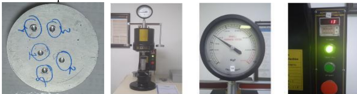
Рисунок 5. Процесс определения твердости исследуемых образцов методом Бринелля
