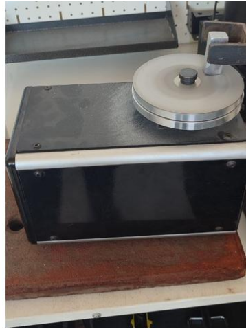
3-rasm. LM24 alyuminiy qotishmalarining quyma qolip turlariga bog‘liq holda yeyilishbardoshlik testi sinov jarayonlari.
