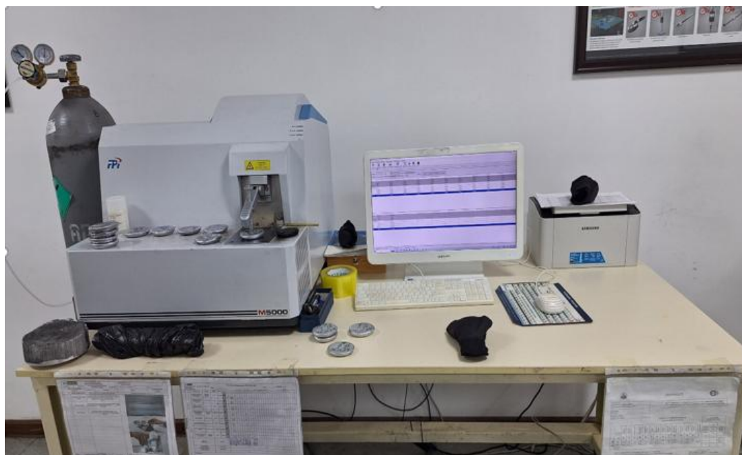
Рисунок 14. Процесс анализа химического состава образцов на приборе СПЕКТРОМЕТР-М5000 Сравнительный анализ результатов с использованием и без использования флюса для исследований
