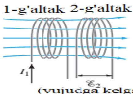
9.13-rasm. Bir g'altakdagi tokning o'zgarishi, ikkinchi g'altakdagi tokni vujudga keltiradi
