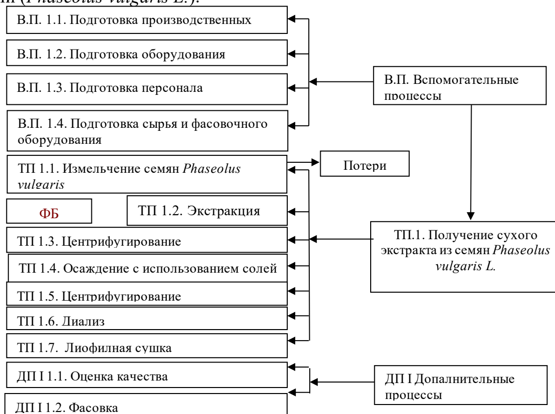
Рисунок 4. Технологическая схема получения сухого экстракта из семян фасоли ( Phaseolus vulgaris L.).
