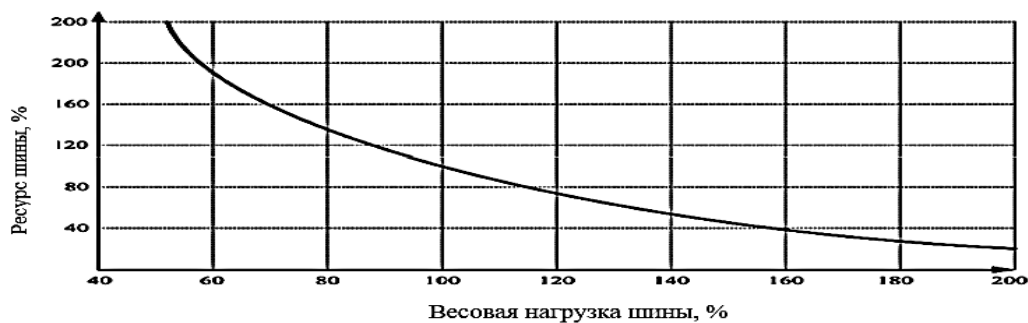
Рис. 4. Влияние весовой нагрузки на ресурс шин в рабочих условиях.
