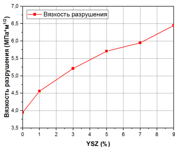
Рис.11. Изменение вязкости разрушения образцов в зависимости от количества YSZ в их составе
