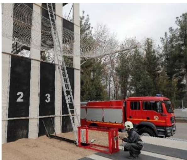
12-расм. Уч тирсакли сурилувчи нарвонни синов дастгоҳи орқали синовдан ўтказиш схемаси.
