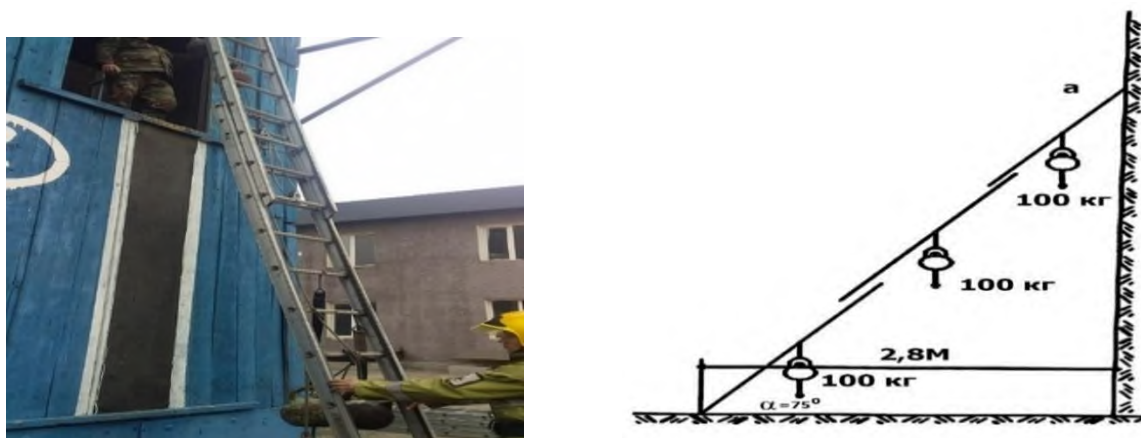
Рис. 3. Схема испытания трёхколенной выдвижной лестницы методом подвешивания груза.
