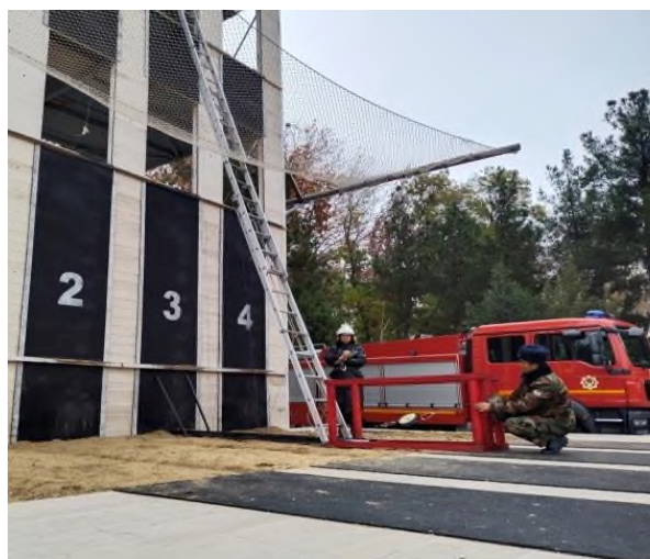
12-расм. Уч тирсакли сурилувчи нарвонни синов дастгоҳи орқали синовдан ўтказиш схемаси.
