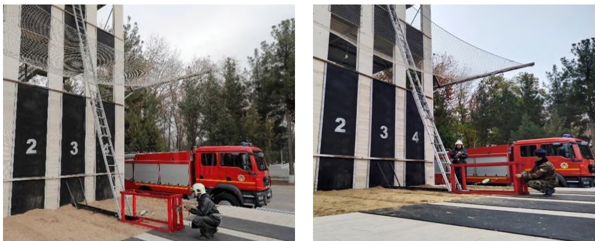
Рис. 11. Схема испытания трёхколенных выдвижных лестниц на испытательном стенде.
