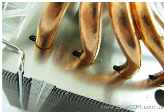
3.10-rasm. Issiqlik quvurlari - protssessor sovutgichining eng muhim qismi.
