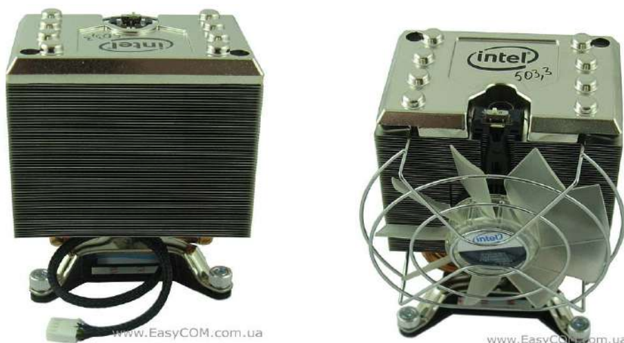
3.11-rasm. Protessor sovutgichi (CPU air cooler), aniqrog‘i Intelning kuchaytirilgan tower tipidagi sovutgichi.
