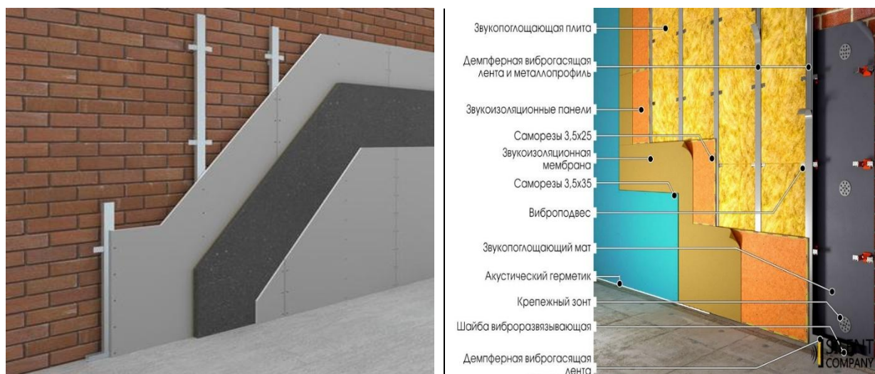
5.7-рasm. Devorning ko'p qatlamli tovush o'tkazmaydigan konstruksiyasi.
