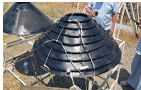
14- rasm. Kesik konussimon quyosh suv isitgichining tajriba namunasi.
