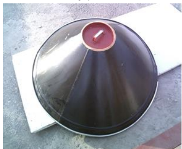
14- rasm. Kesik konussimon quyosh suv isitgichining tajriba namunasi.
