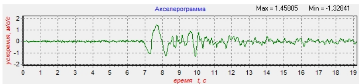
Рисунок 3. Запись реального воздействия землетрясения Нинхэ 1976 года, период колебаний 1 секунда
