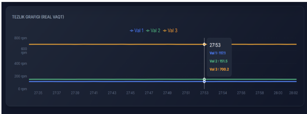
Рисунок 9. Окно тренда/мониторинга SCADA (график скорости и индикаторы состояния)
