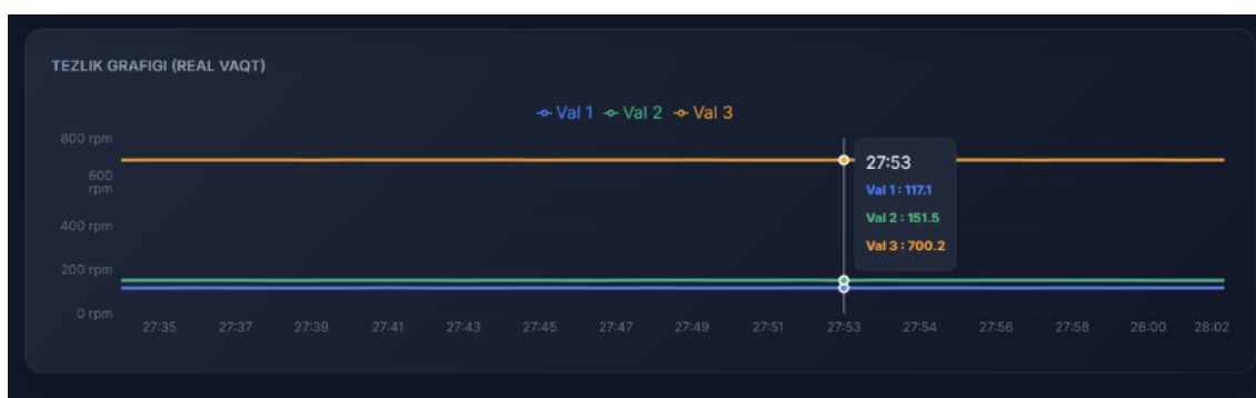
9-rasm. SCADA trend/monitoring oynasi (tezlik grafigi va holat indikatorlari)
