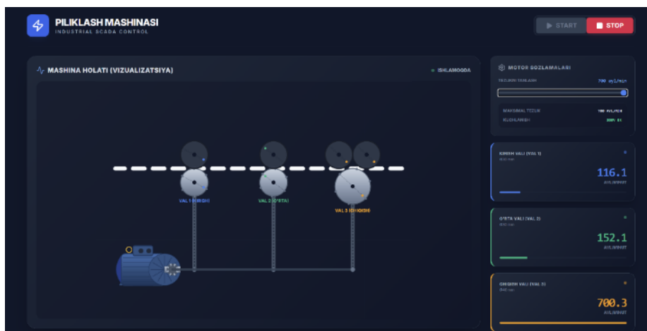
Рисунок 8. Главный экран SCADA ленточной машины (интерфейс- HMI)
