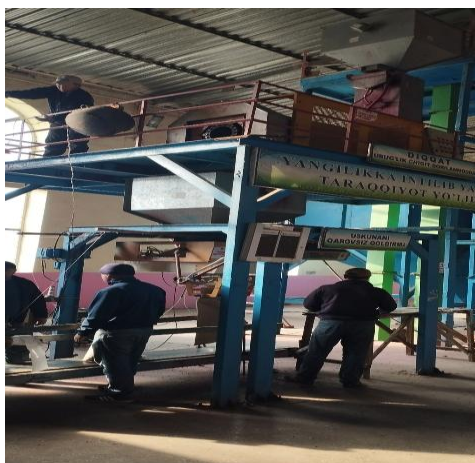
15-rasm. Dorilash uskunasi tarkibida qo'llaniladigan yangi konstruksiyadagi qorishtirish barabanining fotosuratlari
