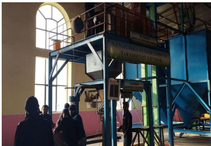
Рис.15. Фотографии смесительного барабана новой конструкции, используемого в составе установки для протравливания семян
