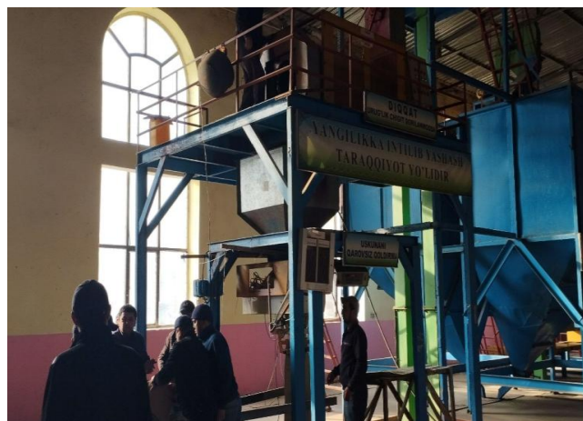
15-rasm. Dorilash uskunasi tarkibida qo'llaniladigan yangi konstruksiyadagi qorishtirish barabanining fotosuratlari
