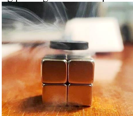
13-rasm. Suyuq azotda (77 K) sovutilgan Y123 namunasining NdFeB magnitlari ustida barqaror levitatsiyasi (Meyssner effektining namoyon boʻlishi).
