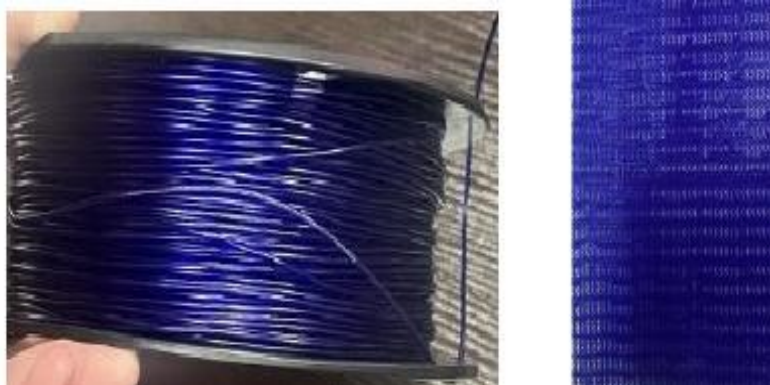
Рис. 6. Заказанный для защитного элемента филамент TPU и экспериментальный образец ткани квадратной формы
