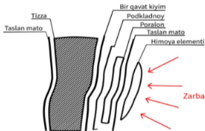
10-rasm. FunkSIONAL kombinezonning tizza sohasi qatlamlar kesimi
