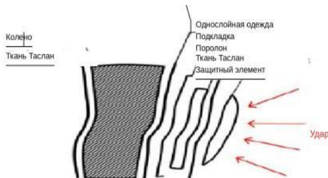
Рис. 10. Послойное сечение коленной зоны функционального комбинезона
