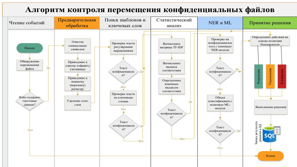
Рис. 2. Блок-схема алгоритма определения конфиденциальности файлов.
