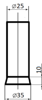
Рис. 8. Опорное кольцо на конце трубы.
