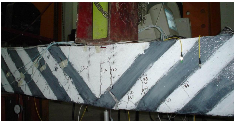
4.18-rasm. To'g'rito'rtburchak kesimli to'sinni yig'iq yuk ostida egilishga sinash
