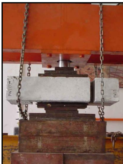
4.10-rasm. Qirqilish tekisligi bo'yicha chiziqli yuklangan maxsus namuna
