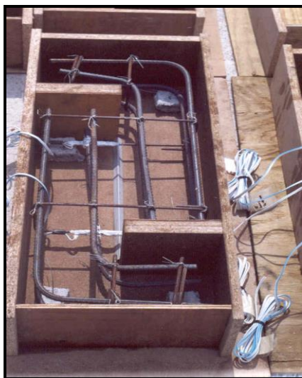
4.9-rasm. Maxsus namunalarda armaturalarning joylashishi
