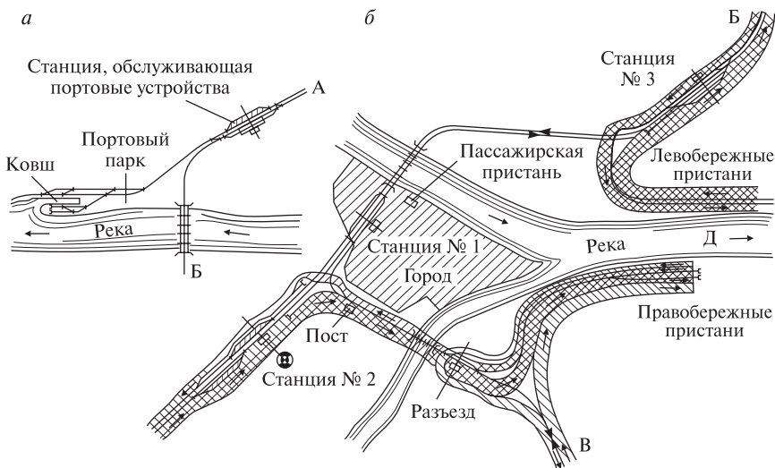
Рис. 31.7. Схема размещения на берегах реки железнодорожных устройств, обслуживающих речные порты: а — на одном берегу; б — на обоих берегах
