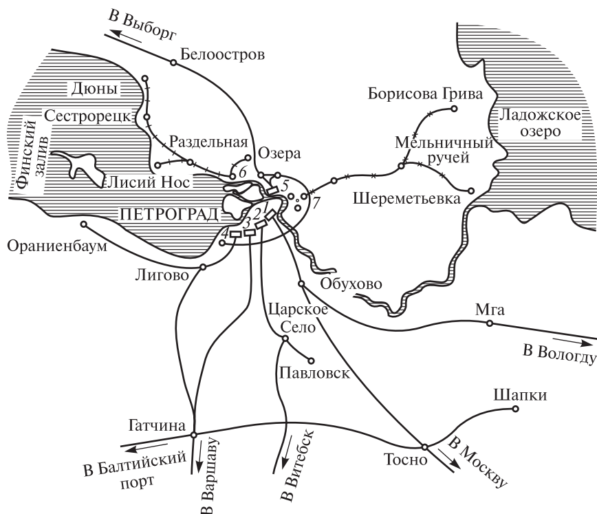
Рис. В4. Схема Петроградского железнодорожного узла (1914 г.). Вокзалы: 1 — Николаевский; 2 — Витебский; 3 — Варшавский; 4 — Балтийский; 5 — Финляндский; 6 — Новодеревенский; 7 — Охта
