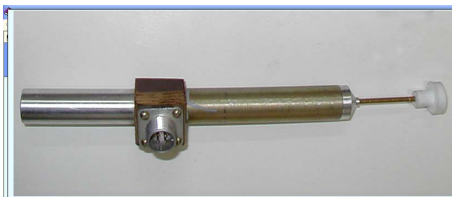
Рис.3.8 Датчик выхода реек топливных насосов высокого давления
