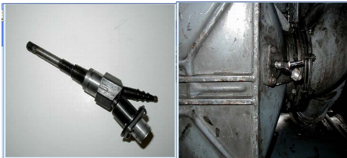
Рис.3.1 Установка приемника давления с датчиком температуры перед воздухоохладителем
