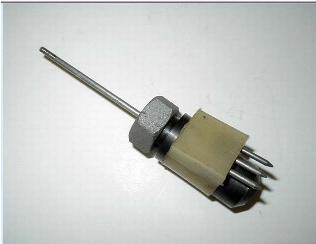
Рис. 3.4 Датчик подъема иглы форсунки
