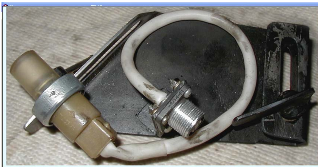
Рис.3.5 Кронштейн с датчиком ВМТ
