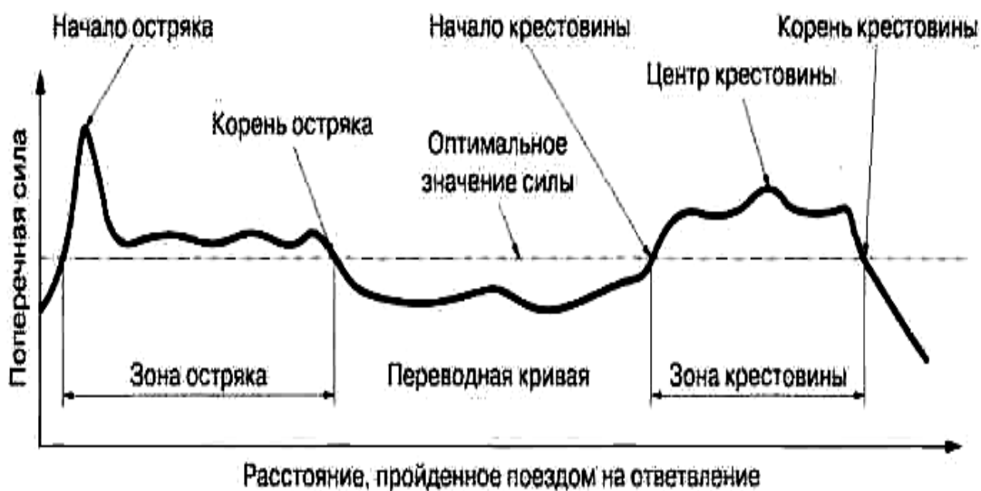
2.2-расм. Стрелкали ўтказгичлардан ўтиш вақтида вужудга келадиган кўндаланг кучларни оптималлаштириш концепцияси
