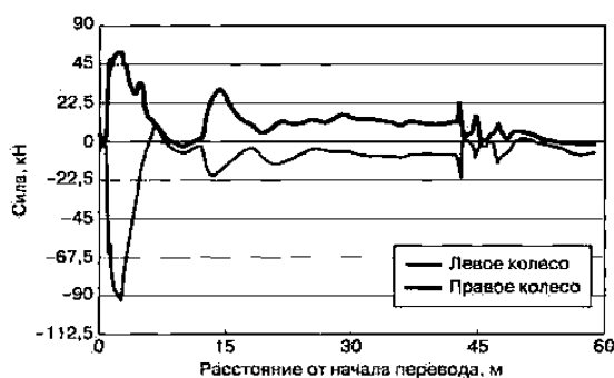
2.3-расм. Модернизациядан ўтишдан олдинги 20-рақамли стрелкали ўтказгичдан ўтиш вақтида вагон ғилдираклари ва рельслар ўртасида ўзаро таъсир кучлари
