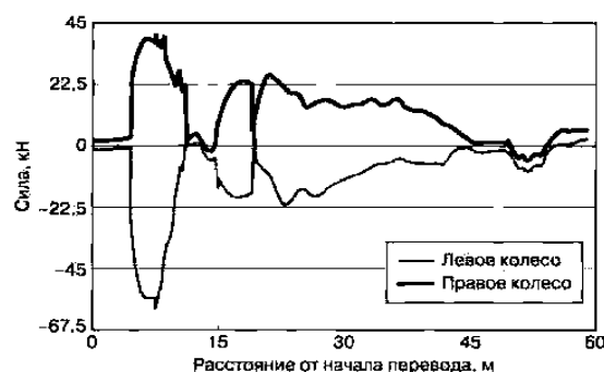
2.4-расм. Модернизациядан ўтгандан кейинги 20-рақамли стрелкали ўтказгичдан ўтиш вақтида вагон ғилдираклари ва рельслар ўртасида ўзаро таъсир кучлари
