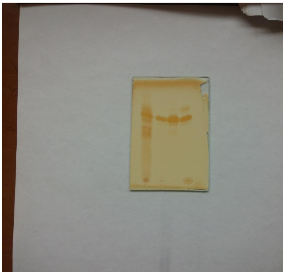
Rasm-2. Delphinium semibarbatum alkaloidlar yig'indisidan cho'ktirilgan metillikakonitin perxloratining namuna bilan taqqoslangan xromatogrammasi.
