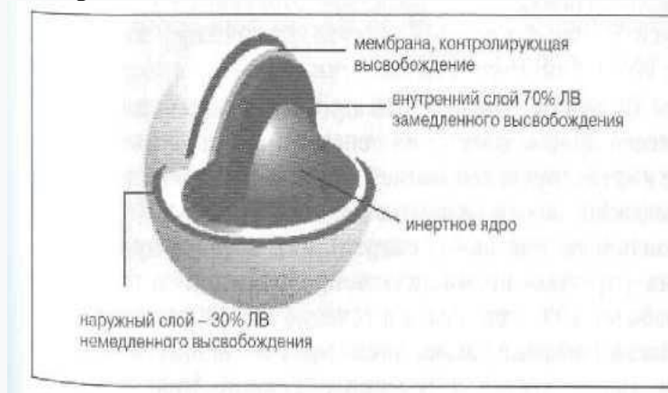
Efoks® Long DSh dagi mikroferalar tuzilishi
