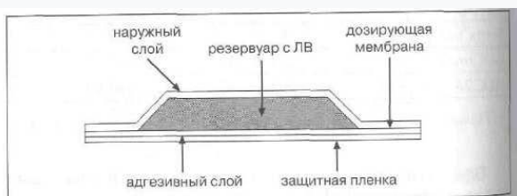
Rezervuar tipidagi fentanil TTS tuzilishi
