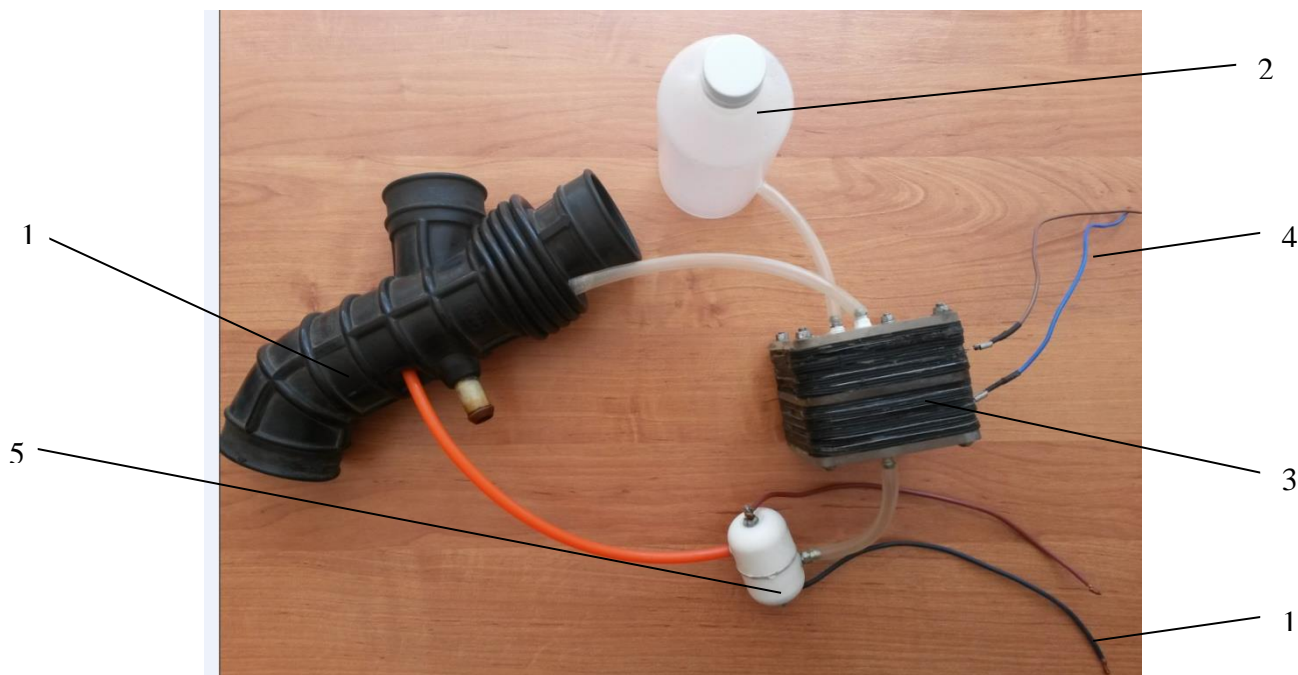
33- rasm. “Neksiya” avtomobili uchun yasalgan vodorod generatori.
