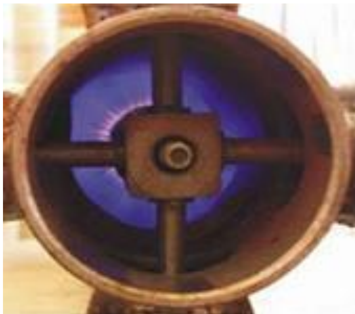
20- rasm. SHaymurovA.nibug‘- ozongeneratori
