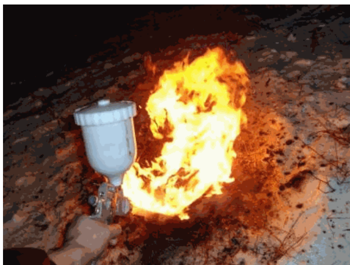
29- rasm. Qizigan metallga suvni sepishda olovning kuchayishi
