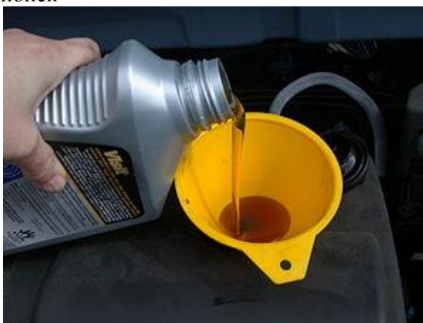
Залив автомасла из герметичной тары в картер двигателя
