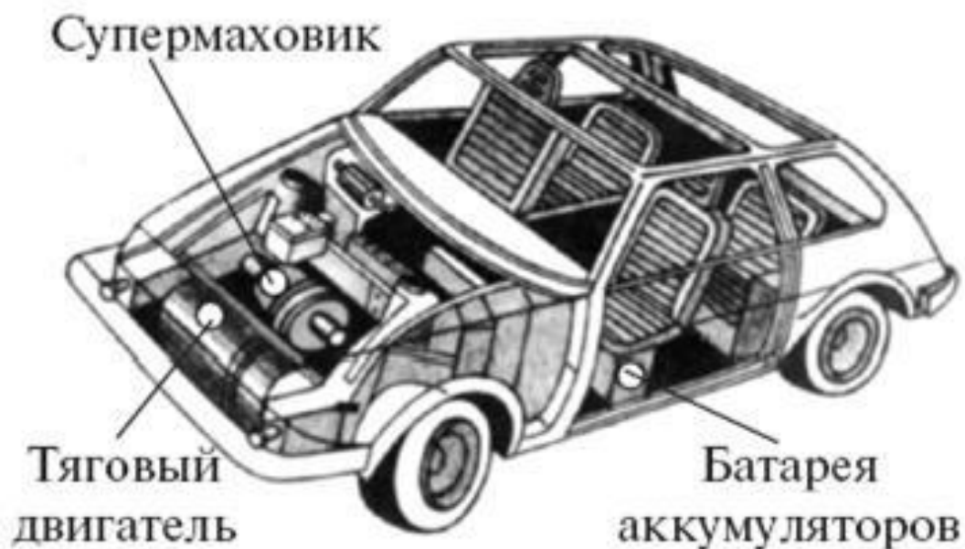
9- rasm. Germaniyada yaratilgan NEKAR elektromobili va uning supermaxovikli kuch qurilmasi
